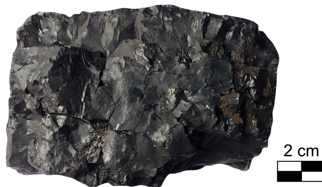
Figure 7. Échantillon de roche. Sa masse volumique est d'environ 1,40 g.cm -3 . La roche est combustible et laisse une trace noire lorsqu'elle est frottée entre les mains ou contre une feuille de papier.
